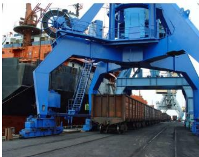
Рисунок 10.3 - Рамний чотирьохстійковий портал коробчатої конструкції
