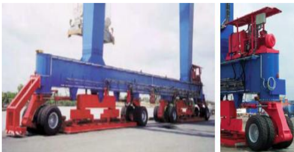
Рисунок 8.2 – Пневмоколісні ходові візки, що забезпечують рух по прямій траєкторії
